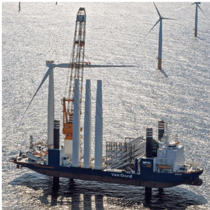
Figuur 29: Schip dat stil ligt met behulp van spudpalen.
