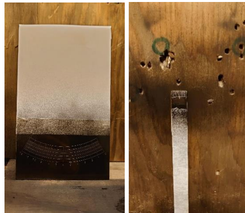
Figuur 140: Zwart spuiten van een aantal onderdelen
