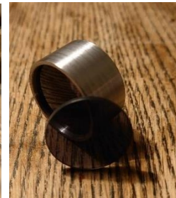
Figuur 157: Opzetbaar verdonkeringsglaasje
