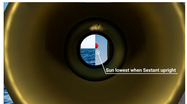
Figuur 79: Sextant wordt heen en weer gewiegd, hemellichaam 'kust' de horizon op het laagste punt
