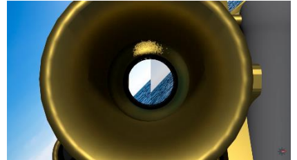
Figuur 66: Side error wordt zichtbaar door de sextant te kantelen
