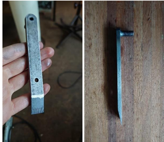
Figuur 141: Ingekorte wijzer
