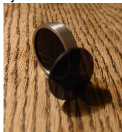
Figuur 152: Opzetbaar verdonkeringsglasje
