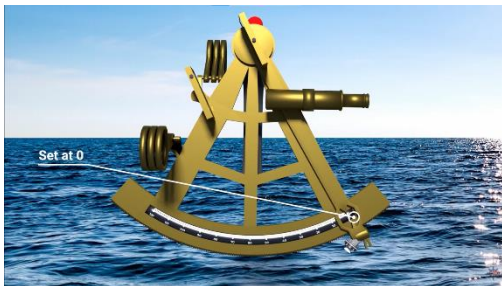
Figuur 68: Sextant afgesteld op 0^\circ
