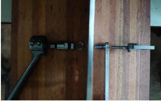
Figuur 147: Volgorde van montage; index spiegel, wijzer, plaat, veerringetje, moertje, moertje, imbuschroefje, (geklemd) hendel
